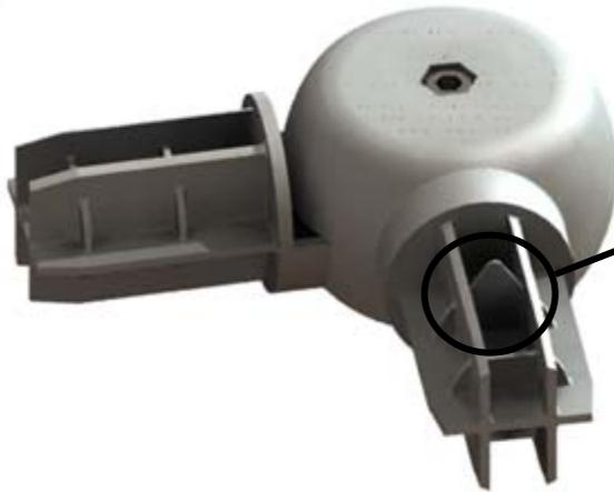
L'angle réglable se compose de 2 parties identiques reliées entre elles par une vis CHC M6 x 35 (la même vis que pour les pieds), l'écrou M6 de serrage étant emprisonné dans son empreinte.
