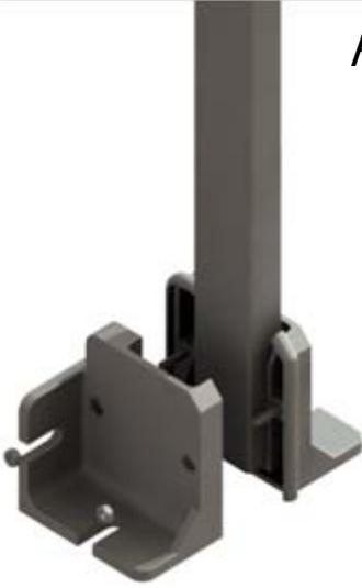
Assemblage du pied avec le montant à l'aide de 2 vis CHC M6 x 35.
